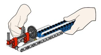
Dieses Modell verfügt über ein Zahnstangengetriebe. Im Gegensatz zu den vorherigen Zahnradanordnungen kann ein Zahnstangengetriebe nur für lineare (geradlinige) Bewegungen eingesetzt werden, nicht zur Herstellung von Drehbewegungen. Beim Drehen an der Kurbel bewegt sich die Zahnstange je nach Drehrichtung des kleinen Zahnrads ("Ritzel") vorwärts oder rückwärts.
