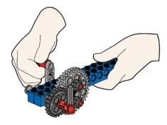
Bei diesem Modell wird die Bewegungsrichtung abgewinkelt. Die beiden Kegelräder geben die Bewegung ohne Kraftund Drehzahländerung weiter, stellen aber einen Winkel von 90° her.
