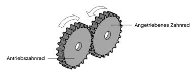
Das Antriebszahnrad wird durch eine äußere Kraft angetrieben, z. B. von deiner Hand oder von einem Motor. Jedes Zahnrad, das direkt von einem anderen Zahnrad bewegt wird, zählt zu den angetriebenen Zahnrädern. Das Antriebszahnrad leitet die äußere Kraft ein, das angetriebene Zahnrad gibt die Kraft wieder ab.
